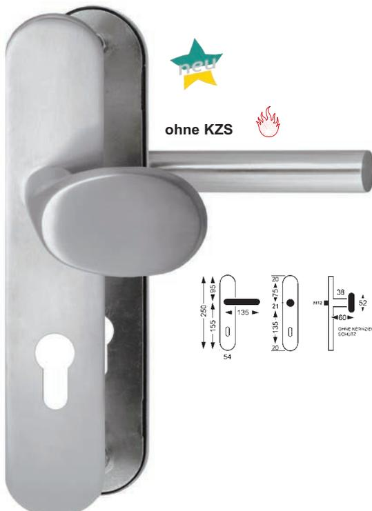
Edelstahl matt gebürstet Stahlunterkonstruktion im Innen- und Außenschild, 3-fach Verschraubung M6, **ohne Kernziehschutz**, Außenschildstärke 13,5 mm, für Türstärke ca. 38 – 63 mm
