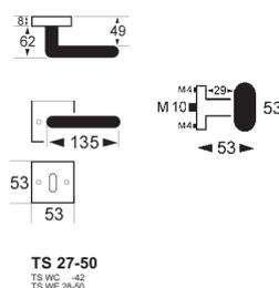
Befestigung mittels Durchzugschrauben M4
