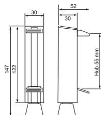
**Türfeststeller aus Stahlblech**
