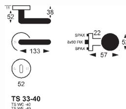
Befestigung mittels Durchzugsspax
