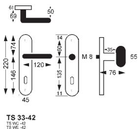
Befestigung mittels Durchzugschrauben und Hülsenmuttern
