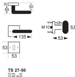
Befestigung mittels Durchzugschrauben M4
