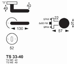
Befestigung mittels Durchzugsspax
