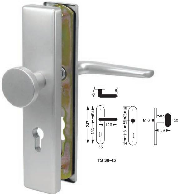
Außenschild mit Aluminium-Grundplatte sowie einer zusätzlichen Metallplatte, zur Verstärkung des Zylinderbereichs. Außenschildstärke **14 mm**, Innenschildstärke 8mm, unsichtbare 3fach Verschraubung mittels M6 Gewindeschrauben, Standard-Befestigungsmaterial für TS ca. 38 bis 45 mm Wechsel-Grt. mit Flachrundknopf  $\varnothing$  50 mm - Innengewinde M6
