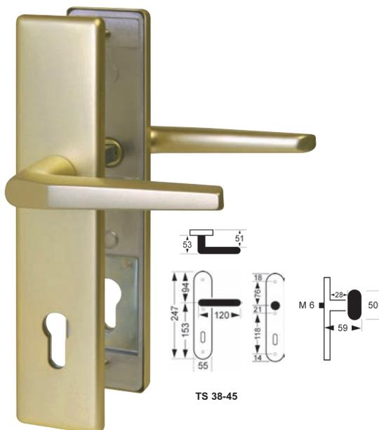
Außenschild mit Aluminium-Grundplatte sowie einer zusätzlichen Metallplatte, zur Verstärkung des Zylinderbereichs. Außenschildstärke **14 mm**, Innenschildstärke 8mm, unsichtbare 3fach Verschraubung mittels M6 Gewindeschrauben, Standard-Befestigungsmaterial für TS ca. 38 bis 45 mm Wechsel-Grt. mit Flachrundknopf  $\varnothing$  50 mm - Innengewinde M6
