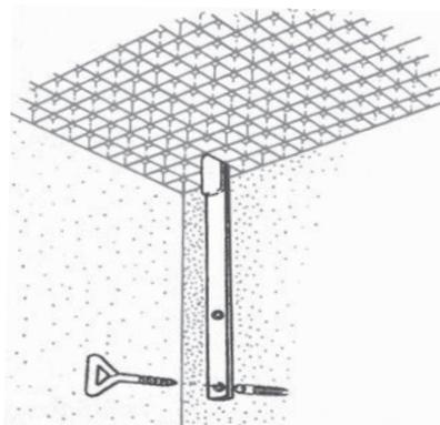
**Gitterrostsicherungen aus Eisen, 280x20x3 mm**
