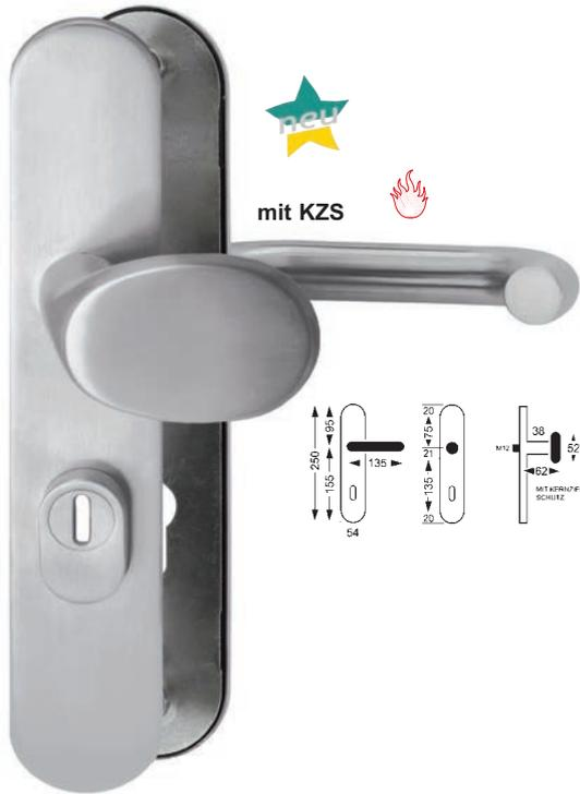
Edelstahl matt gebürstet, Stahlunterkonstruktion im Innen- und Außenschild, 3-fach Verschraubung M6, **mit Kernziehschutz**, Außenschildstärke 15 mm, für Türstärke ca. 38 – 63 mm, für Zylinderüberstände 11-14 mm
